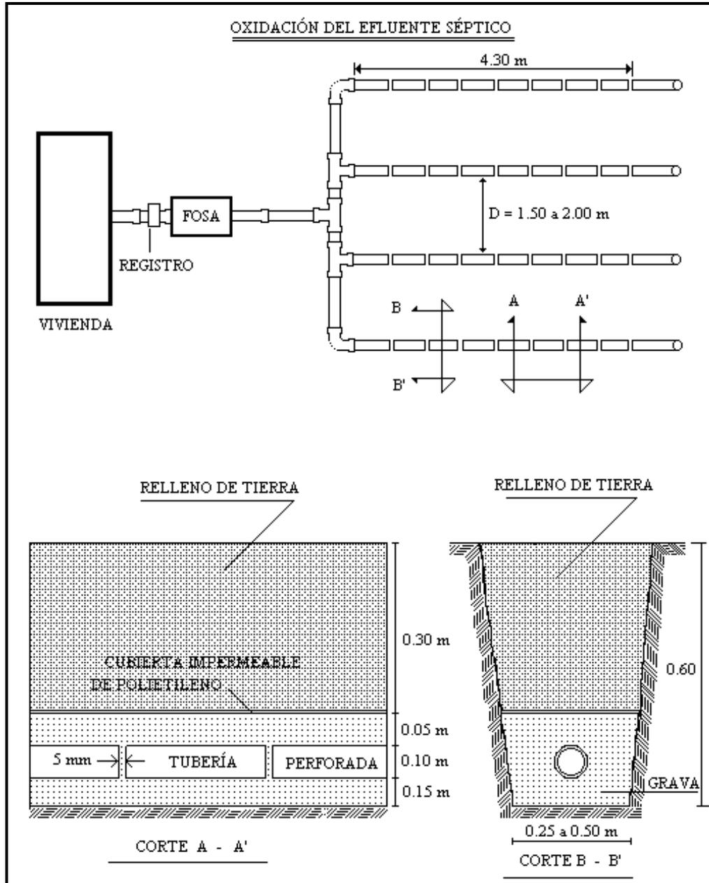
**FIGURA 7. ZANJAS DE INFILTRACIÓN**
