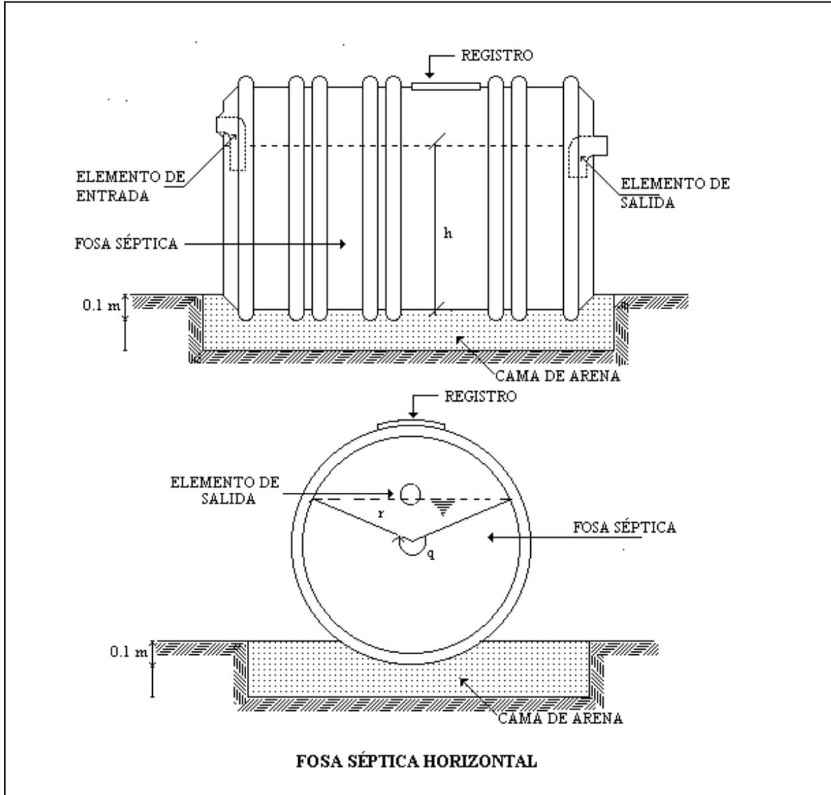
**FIGURA 4. COLOCACIÓN DE FOSA SÉPTICA HORIZONTAL
