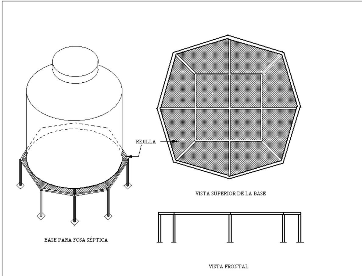
**FIGURA 5. BASE PARA FOSA SÉPTICA VERTICAL**
