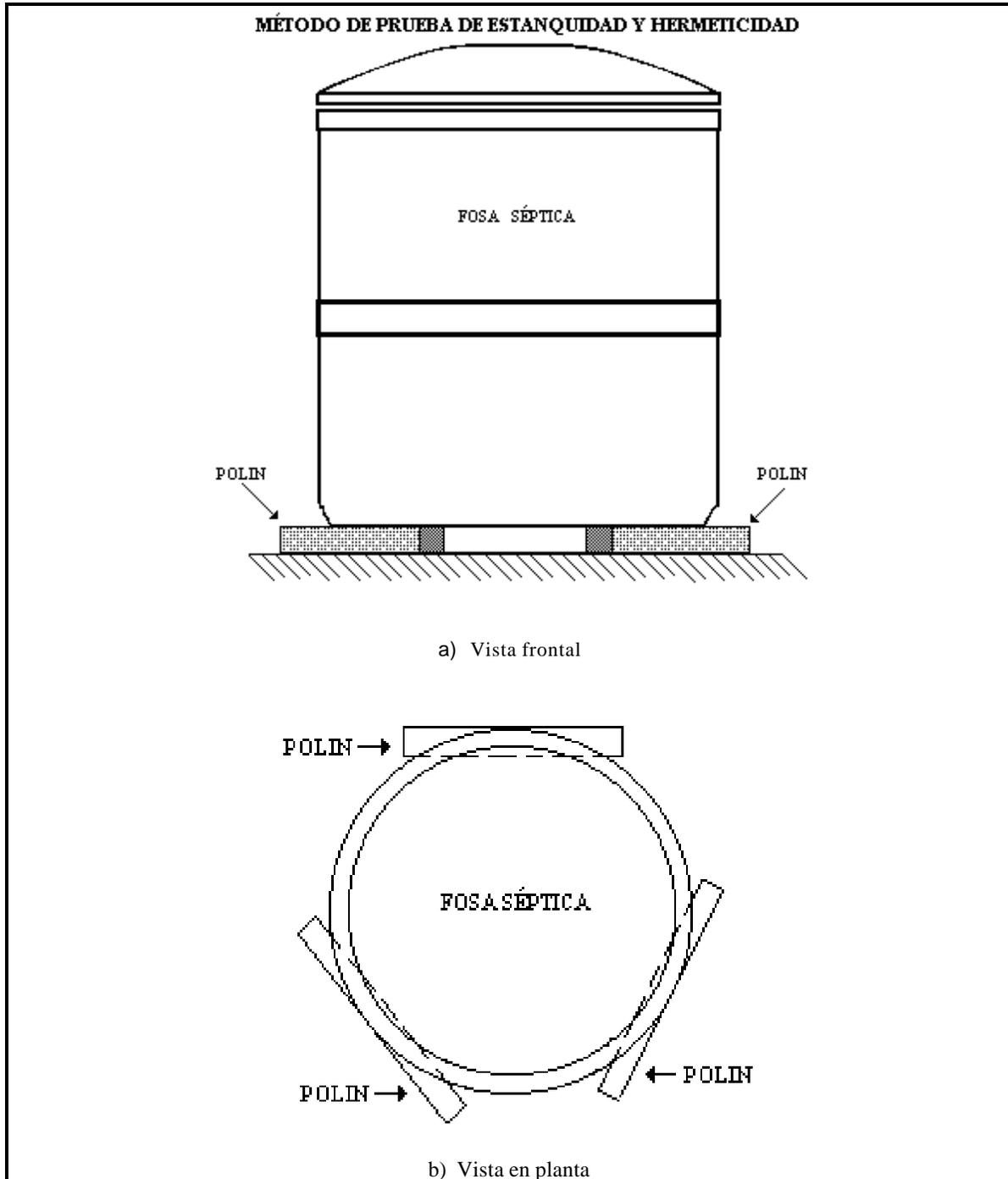
**FIGURA 3. COLOCACIÓN DE FOSA SÉPTICA VERTICAL SOBRE
