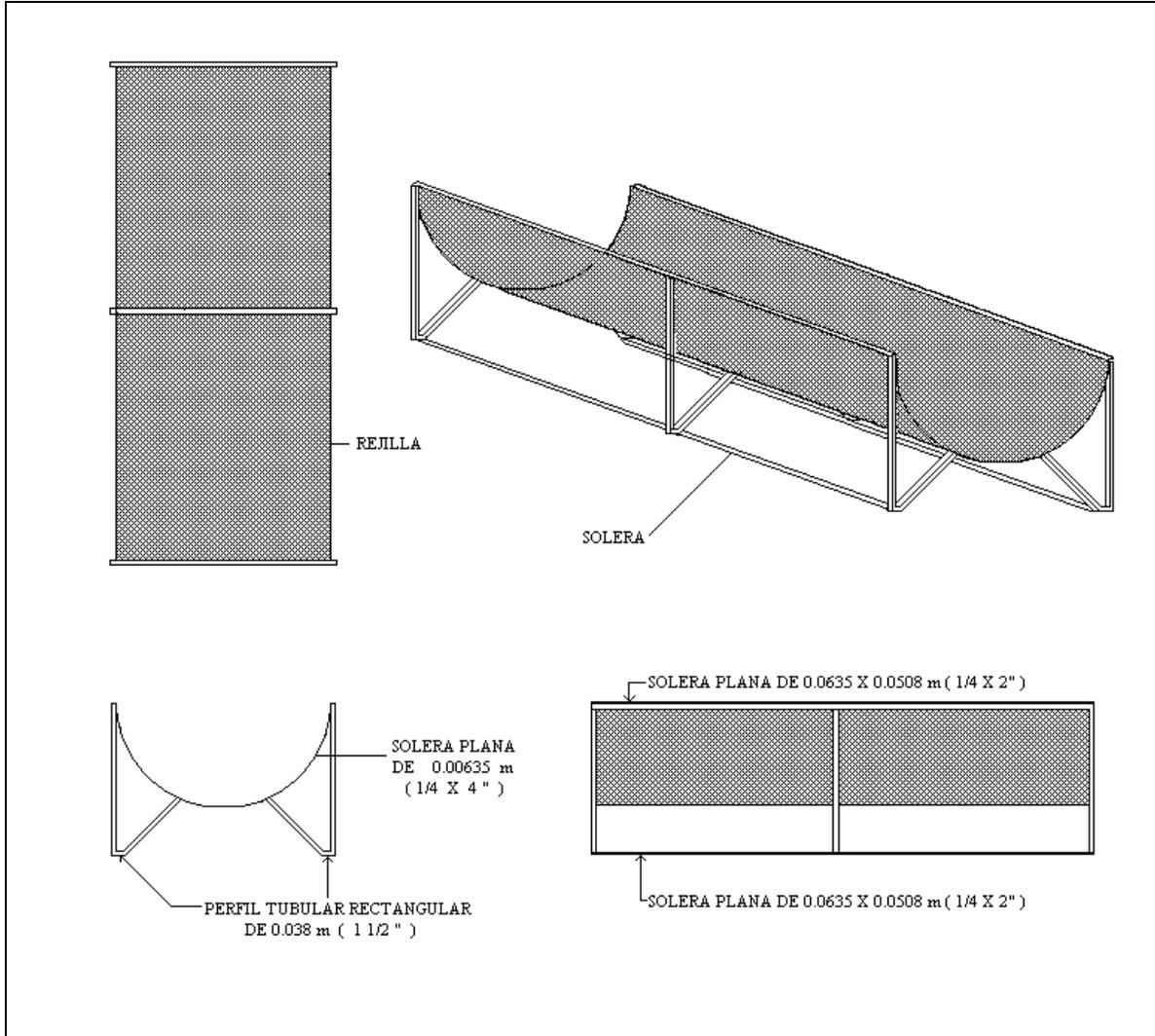
**FIGURA 6. BASE PARA FOSA SÉPTICA HORIZONTAL**
