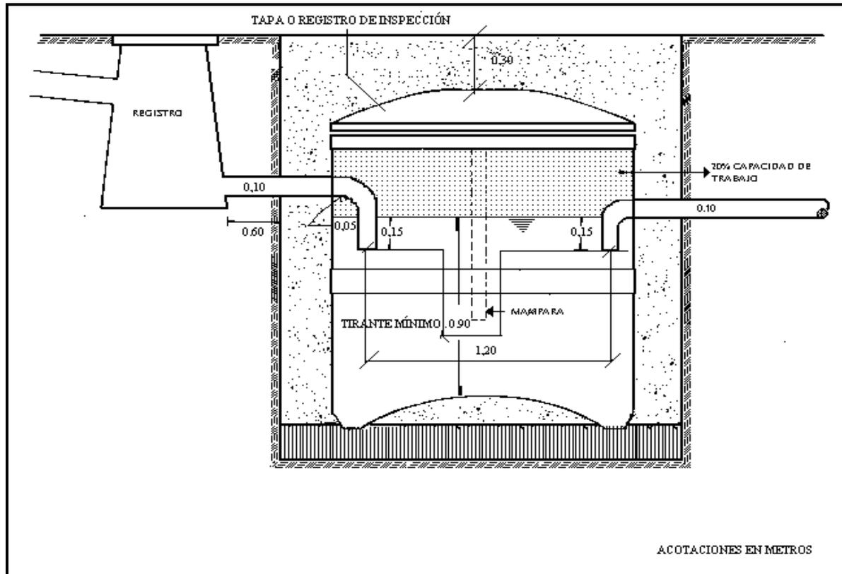
**FIGURA 2. FOSA SÉPTICA PREFABRICADA**
